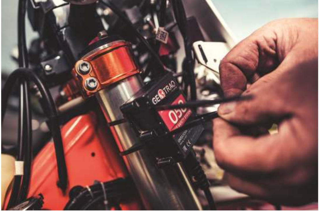
GPS takip cihazının kablo bağları ile süspansiyon koluna sabitlenmesi.
