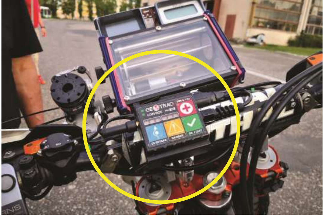
Com Box ünitesinin braket ile birlikte kablo bağları kullanılarak gidona montajı.
